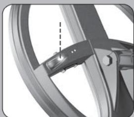
Светодиод на катушке дает 20 длинных, последовательных вспышек, что указывает, на то что она просыпается и рекалибруется. Как только рекалибровка завершена, катушка становится готовой к эксплуатации и ее светодиод мигает каждую секунду.
